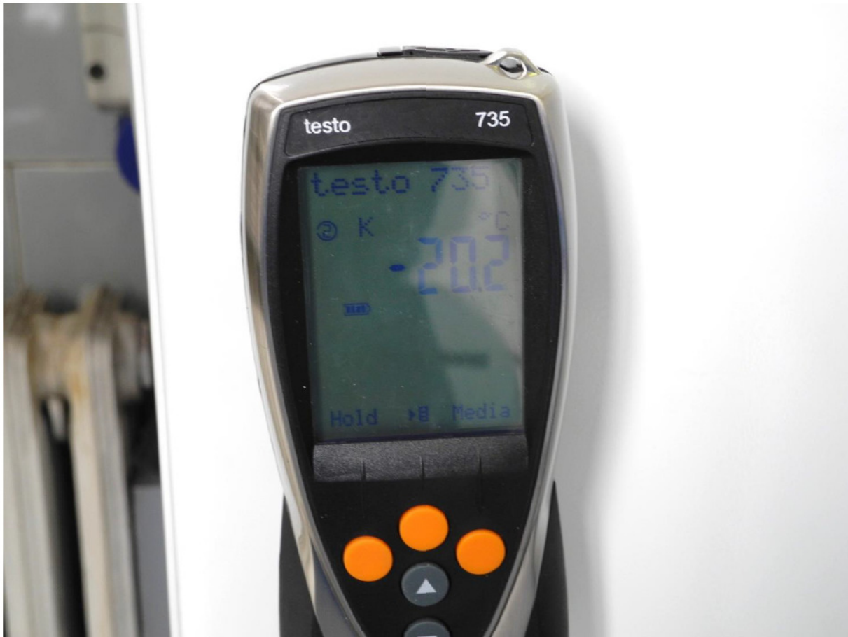
Figura 2. Misurazione della temperatura del frigo-congelatore attraverso sonda certificata Testo 735-2.
