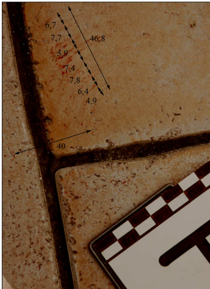
Foto 51: impronta già riprodotta a foto 1, su cui sono state effettuate delle misurazioni tra gli elementi visibili (valori in mm) Cfr. didascalia relativa alla Foto 52.
