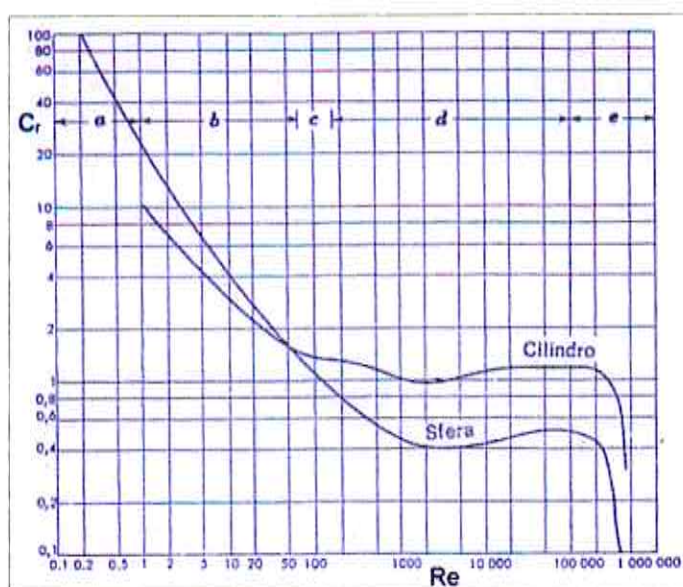
Fig. 50: il grafico di C_r vs Re
