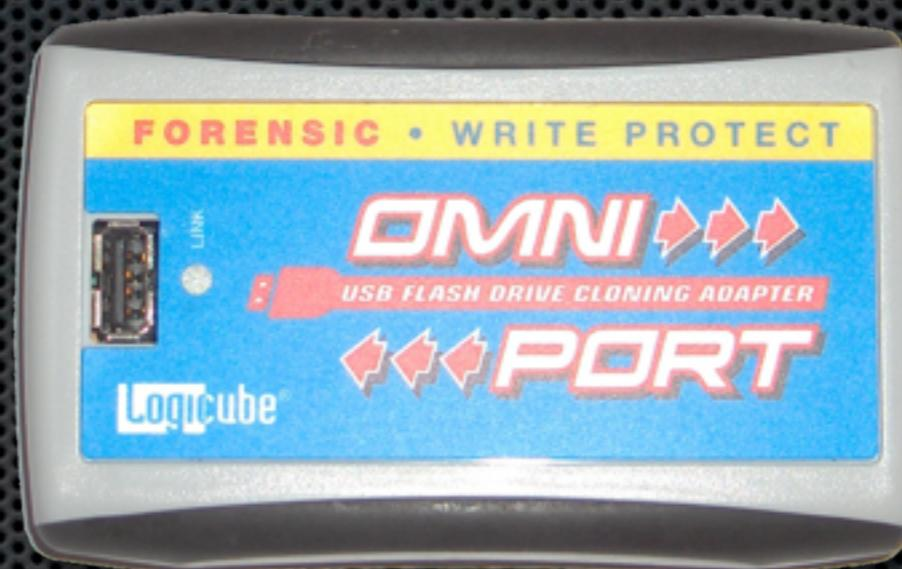
Lo strumento blocca la scrittura sul supporto USB sottoposto ad analisi così da rendere le operazioni Ripetibili
