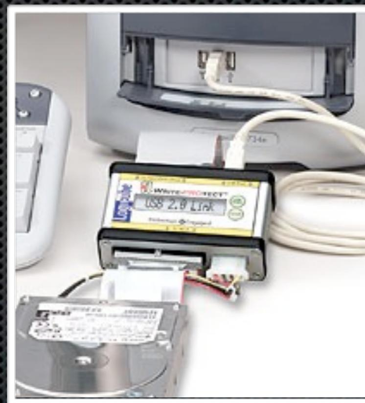
Lo strumento blocca la scrittura sul supporto sottoposto ad analisi così da rendere le operazioni Ripetibili
